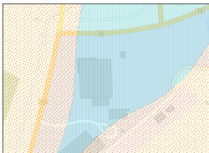
Auszug aus der geologischen Karte (M1:50.000; GeoLa-GK50) mit den geologischen Einheiten "Künstliche Ablagerung" (vertikal-blau-gestreift) und "Moräne (Till), würmzeitlich" (rot-gepunktet dargestellt). ↴
