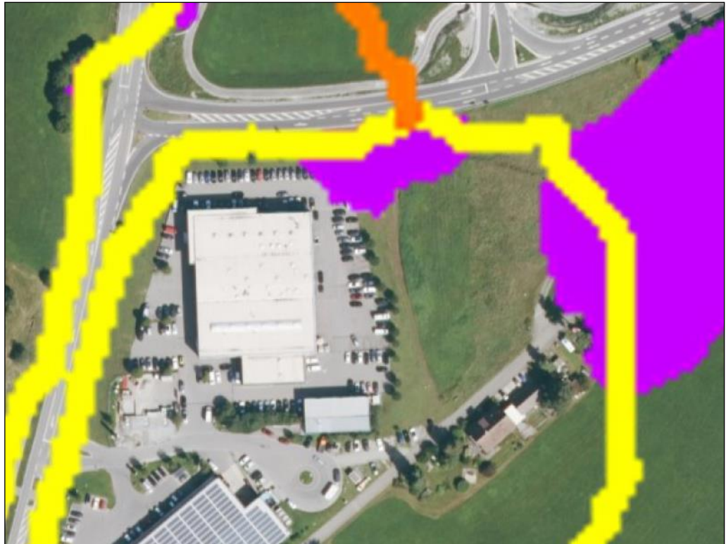
Hinweiskarte für Oberflächenabfluss und Sturzflut“ (HiOS-Karte) mit Aufstaubereich (lia) und möglichen Fließwegen bei Starkregen (gelb).
